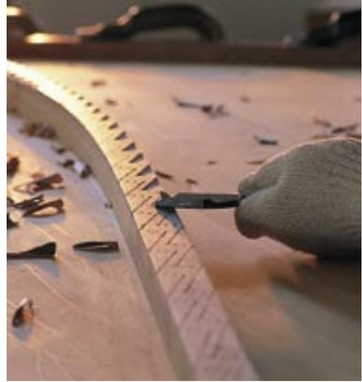
leihen. Bösendorfer beispielsweise hat einen unverkennbar warmen und weichen Klang, der dennoch sehr tragfähig ist. Um den Resonanzboden schwingungsfähig zu machen, muss man ihn unter Spannung setzen. Dies bewirkt die für die Schwingungsfähigkeit maßgebliche Bombierung (Wölbung). Es gibt vier verschiedene Wege, um diese Bombierung zu erreichen. Ich möchte hier nur die gebräuchlichste beschreiben:
